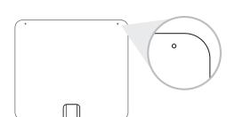
Inserte dos tachuelas (no incluidas) en los dos agujeros en la parte superior de la antena.
