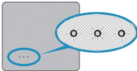
Mueva la antena hasta que el medidor de señal muestre al menos el segundo indicador. Para obtener el mejor rendimiento, intente que se muestre el tercer indicador.
